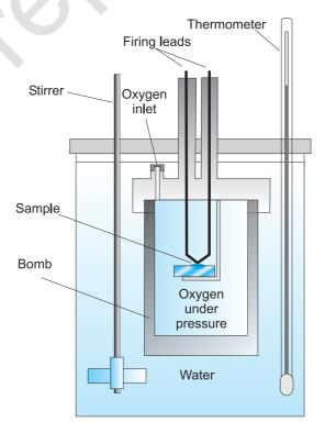
Fig. 6.7 Bomb calorimeter
