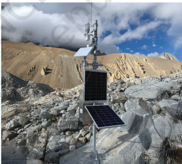
चित्र 2.12 — सिक्किम की एक हिम-झील में स्थापित स्वचालित मौसम केंद्र
