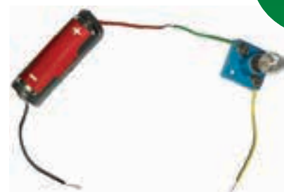
चित्र 3.15 — (क) विद्युत चालन परीक्षण-यंत्र
