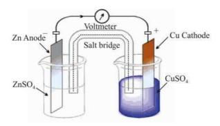
Cell diagram: Zn | Zn<sup>2+</sup> || Cu<sup>2+</sup> | Cu
